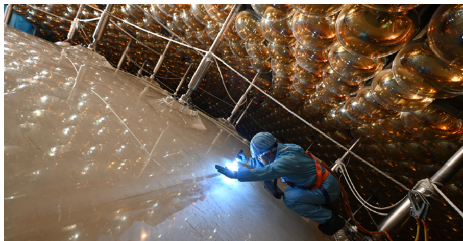
La sphère acrylique de JUNO et ses PMTs. © IHEP/Liu Yuexiang for the JUNO collaboration.
