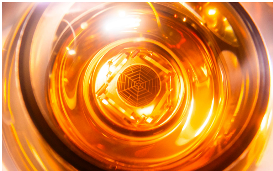
« CEI d'un télescope à neutrinos », détail d'un capteur de lumière Tcherenkov du télescope à neutrinos KM3NeT/ORCA. © Hugo Pardinilla / CPPM / CNRS.
