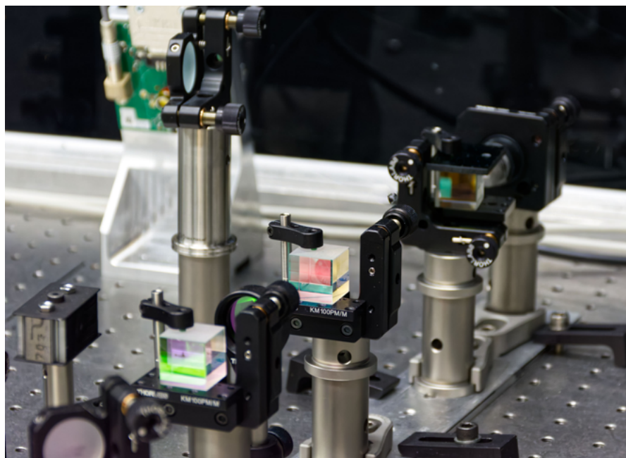
Cette photo montre le système d'injection laser utilisé dans l'expérience Virgo pour mesurer l'intercalibration des sphères métalliques des calibrateurs optiques. © Bernard Revillier/LAPP/CNRS.
