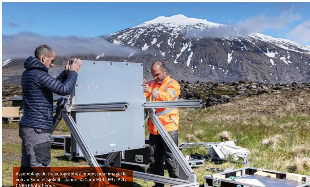
Assemblage du trajectographe à muons pour imager le volcan Snæfellsjökull, Islande . © Carol MULLER / IP21 / CNRS Photothèque
