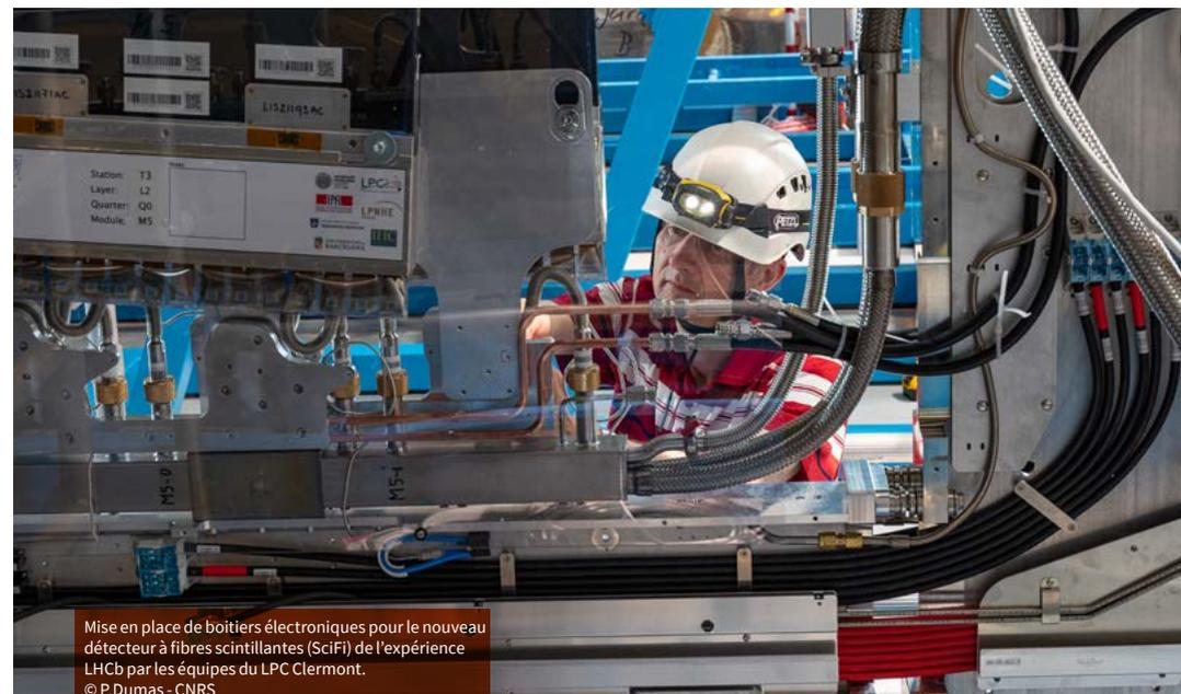
Mise en place de boîtiers électroniques pour le nouveau détecteur à fibres scintillantes (SciFi) de l'expérience LHCb par les équipes du LPC Clermont.
