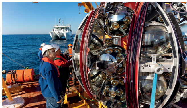
Mise à l'eau des modules optiques des lignes ORCA pour le détecteur de neutrinos KM3Net, télescope à neutrinos de seconde génération © Patrick Dumas - CNRS Photothèque
